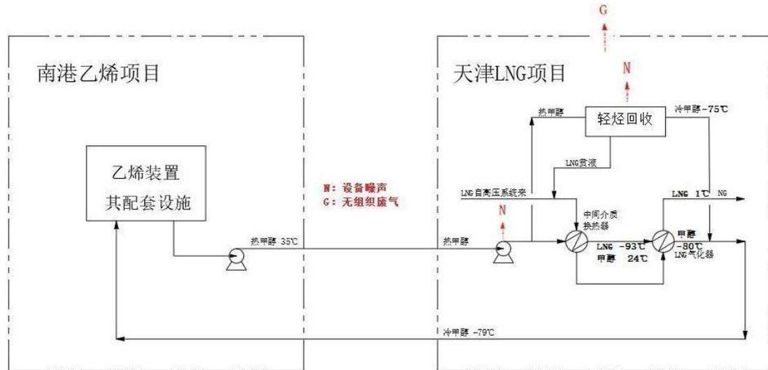
图 2 环评阶段-冷热能互换站工艺流程及产污环节图
